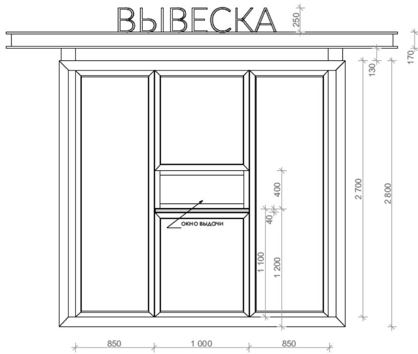
Рис. 23 Вариант исполнения в виде киоска
